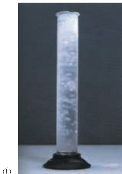
شکل ۱۶ (آ) هوای مایع (ب) تقطیر جزء به جزء هوای مایع
